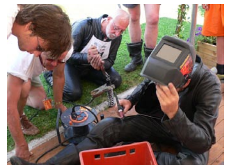
Holländische Experten beim Schweissen eines hinteren Federbeins.
