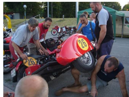
Letzte Reperaturarbeiten am Gespann, die gebrochene Halterung wird geschweisst.
